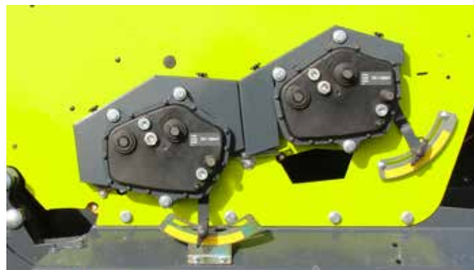
A vetési mennyiség precízen, fokozatmentes hajtóművel állítható.
