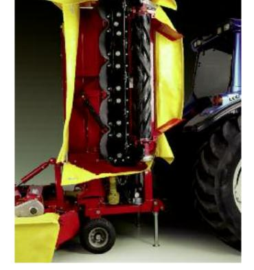
Ecco i vantaggi di una manutenzione rapida: si può procedere alla sostituzione dell'ingranaggio del disco, togliendo il disco ed il supporto, senza smontare tutto il gruppo falciante.
