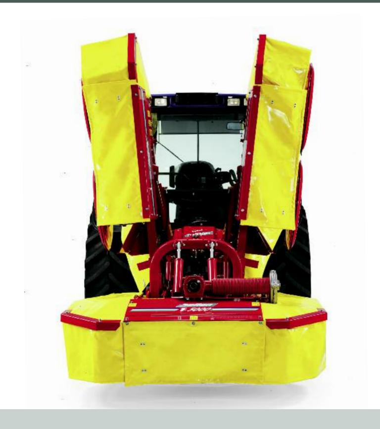
Per il trasporto su strada della vostra falciatrice viene For road transport of the mower, the side elements are utilizzato il sollevamento degli elementi laterali tramite lifted by means of hydraulic pistons. pistoni idraulici.
