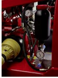
La centralina idraulica é stata costruita seguendo le vigenti normative europee, per esempio é dotata della valvola paracadute che controlla il flusso dell'olio.
