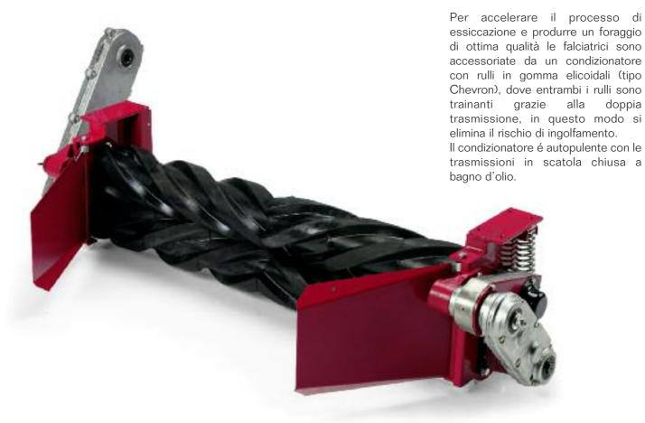
Il foraggio, passando attraverso i rulli, viene compresso e questo procedimento fa aprire lo strato ceroso esterno degli steli, facendone uscire l'acqua superflua, mantenendo però inalterati la consistenza e tutti i principi nutritivi.
