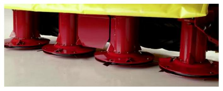
Quando il terreno è umido o paludoso e volete una falciatura veloce e sicura, il sistema a tamburi è la scelta migliore. Di costruzione semplice, ma solida e robusta, il tamburo ha un asse portante fisso e gruppi di trasmissione opportunamente dimensionati. Il disco inferiore "folle", che ruota liberamente, permette al disco di taglio di non affondare nel suolo, adeguandosi così alle diseguaglianze del terreno.
