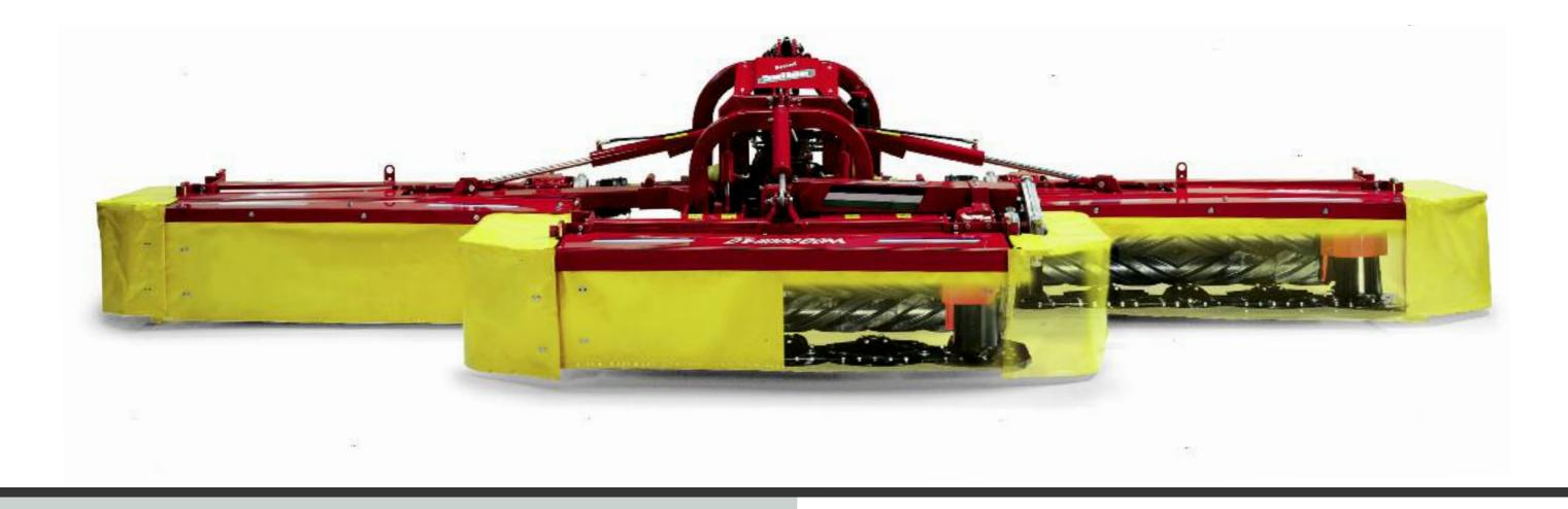
Le falciatrici combinate COMBI-D580 e COMBI-D580GM sono composte da tre elementi falcianti a 5 dischi, uno frontale e due laterali, montati anteriormente, da applicare ad un trattore con presa di forza frontale.
