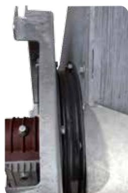
Gelagerte Drehplatte mit Kugeln für die Schwenkbewegung der Luftführung
