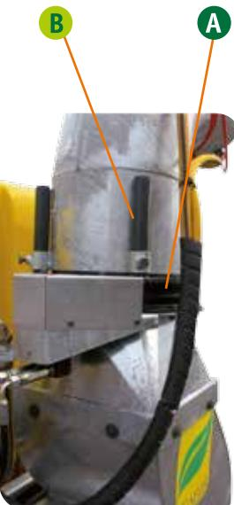
Das Sprühgerät "Turbine Overland" wurde für Hochkulturen im freien Feld und zur Anwendung im Gewächshaus entwickelt. Der Kanonenkopf kann durch einen optionalen Hydraulikmotor 180° rotieren (A), oder manuell eingestellt werden. „Overland“ ist außerdem mit einer speziell entwickelten Hochverstellung ausgerüstet, um sich den verschiedenen Behandlungshöhen anzupassen.
