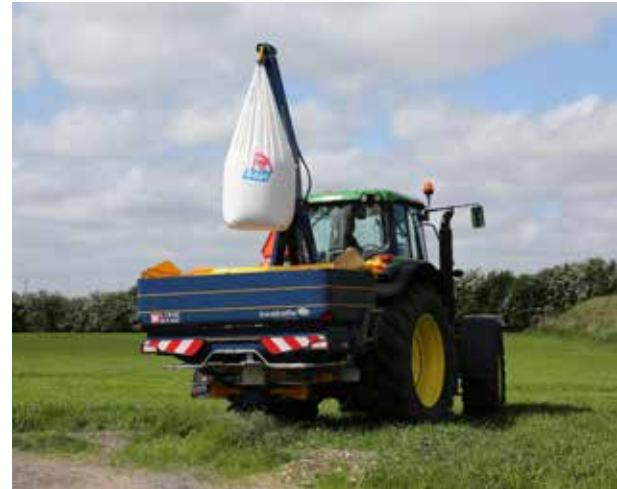
BXL1300 akár 1.300 kg-ot meg tud emelni, és akár 3.300 literes műtrágyaszóróval is használható.
