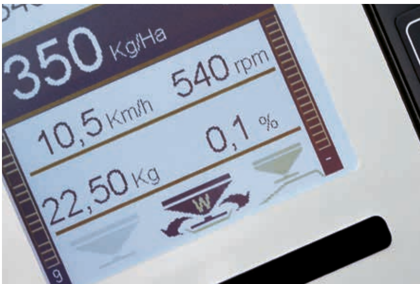
A súlymérős rendszerrel szerelt műtrágyaszórók kalibrációja menet közben automatikusan történik.
