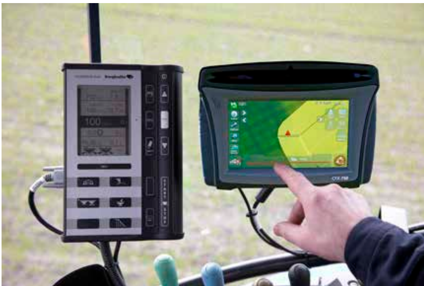
Trimble CFX750 sorvezető összekötve CALIBRATOR ZURF-fel
