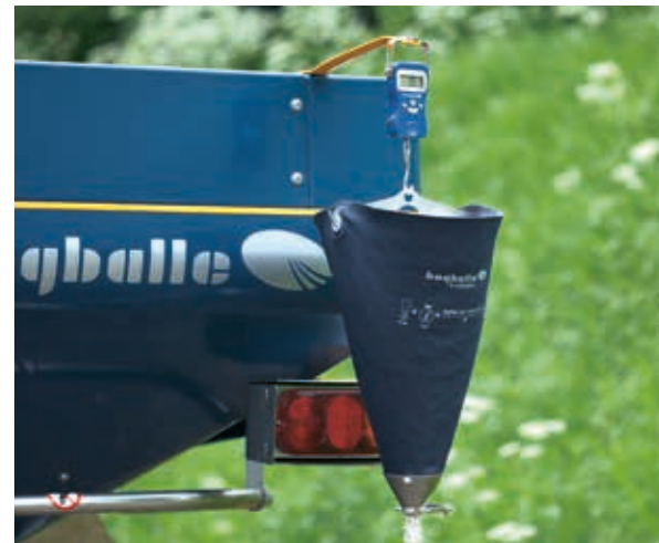
Az S-indicator kalibráló szettel egy perc alatt az adott műtrágyához állíthatja a szórót.
