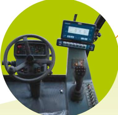
Cabina con regolazione idraulica in altezza, ammortizzata con accumulatore d'azoto.
