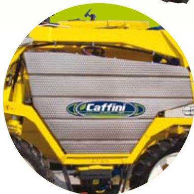
Serbatoi in acciaio inox ( 2 x 1.400 l), posizionati nella parte bassa del polverizzatore, per poter garantire un'ottima stabilità della macchina. Un esclusivo sistema automatico con gestione elettronica permette il caricamento omogeneo dei 2 serbatoi.
