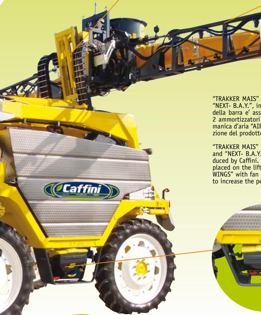
"TRAKKER MAIS" si avvale delle conosciute ed innovative barre "H.B.L." & "NEXT- B.A.Y.", in acciaio o alluminio, prodotte da Caffini. L'ammortizzazione della barra e' assicurata da un accumulatore d'azoto sul sollevamento e da 2 ammortizzatori pneumatici sull'equilibratore. Quale optional e' prevista la manica d'aria "AIR WINGS" con 720 mm di ø, ideale per aumentare la penetrazione del prodotto chimico nelle coltivazioni.
