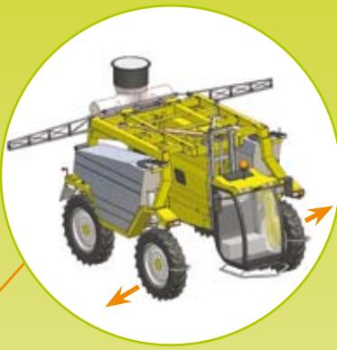
Regolazione idraulica della carreggiata da 200 cm fino a 300 cm tramite un esclusivo ed innovativo sistema a compasso.
