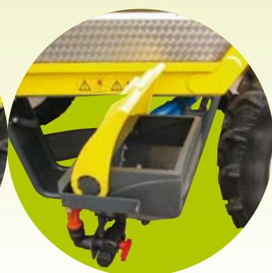
Premixer per la preparazione in automatico della miscela chimica con lava-barattoli integrato. Supporto estraibile a pantografo.
