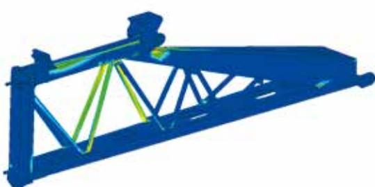
Die Berechnung der Strukturen und ihrer Belastungen während der Behandlungsphasen ermöglichen die Verwendung von überaus widerstandsfähigem Spezialstahl, die sich voneinander nach notwendiger Beanspruchung unterscheiden. Die Stange „045“ besteht aus 8 sehr widerstandsfähigen verschiedenen Stahlarten. Damit die Festigkeit des Spritzgestänges garantiert werden kann, sind die Zylinderschäfte der hydraulischen Zylinder eingefahren, wenn die Gestänge geöffnet sind.
