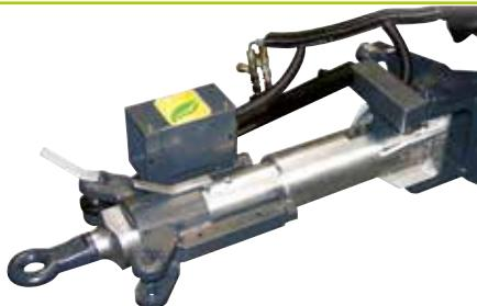
**"Trailmatic"**: Lenkbare Deichsel mit elektronischer Steuerung, durch einen Sensor am Zughaken. Elektroventile steuern die Zylinder die am Traktor gekoppelt sind und ermöglichen den spurgetreuen Nachlauf der Spritze. Es kann während der Arbeit auf Straßenfahrt blockiert werden.
