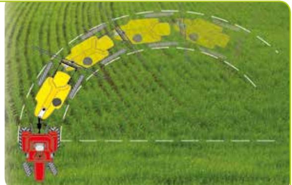
**"Trailmatic"** Руль управления "Trailmatic" с электронным обеспечением посредством датчика подсоединенного к буксируному крюку. Управляется электроклапанами цилиндра, подсоединенными к трактору, позволяющими опрыскивателю идти по следам трактора. Возможность блокирования в течение продвижения и обработки.
